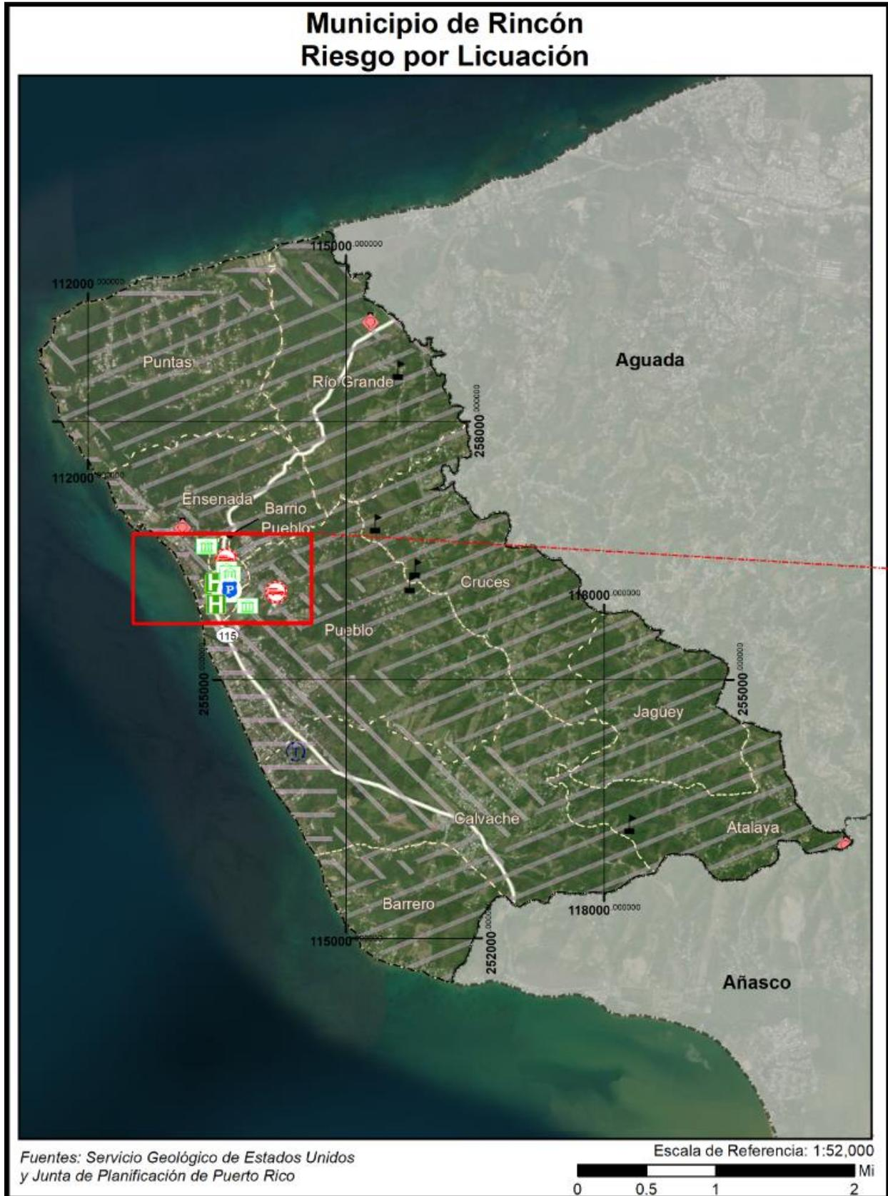
Figura 16: Áreas de riesgo por licuación a causa de terremoto en el Municipio Autónomo de Rincón (cont.)
