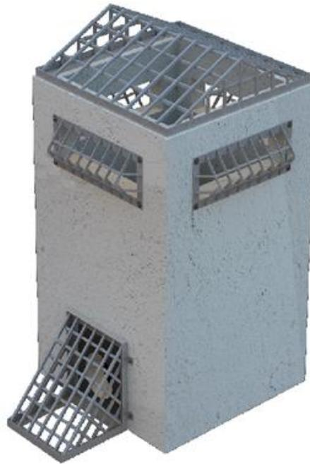
**Figura 6.4 Detalles típicos de rejillas para escombros y basura en diferentes tipos de aperturas en una estructura de salida.**
