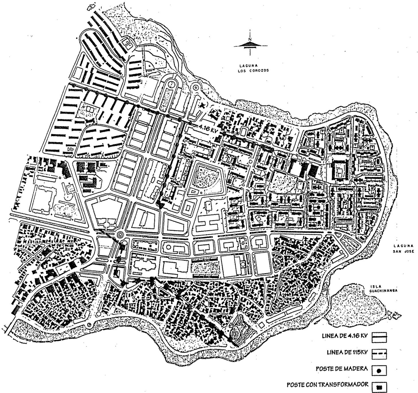
*Ilustración III-14 - Sistema de Energía Eléctrica Existente*
