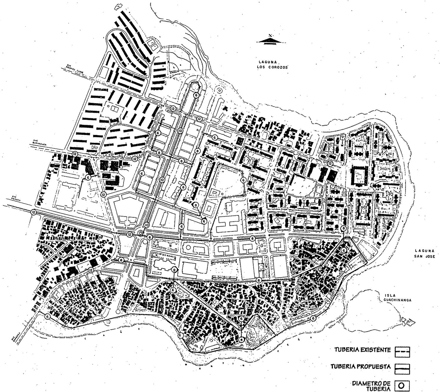
*Ilustración III-30 - Sistema de Agua Potable Propuesto en Terrenos Centrales*
