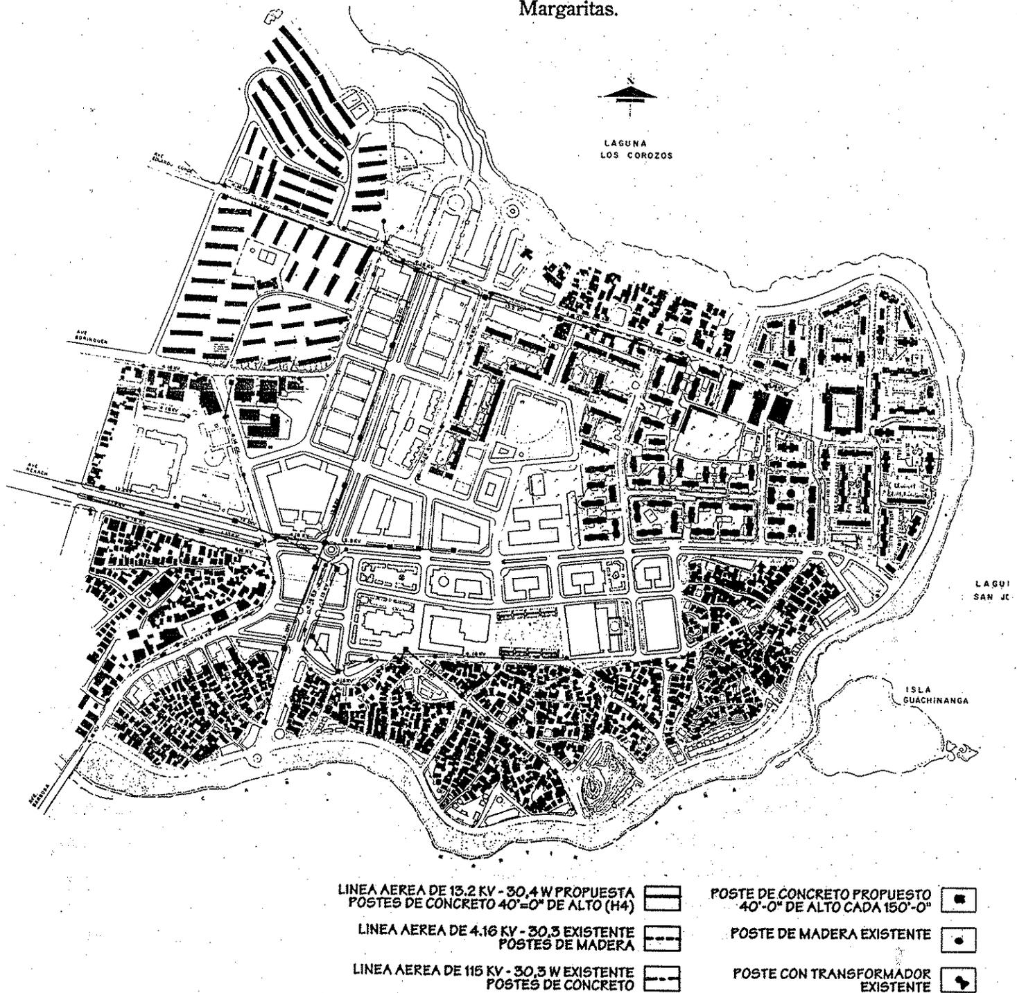
Ilustración III-36 - Sistema de Energía Eléctrica Propuesto en Terrenos Centrales
