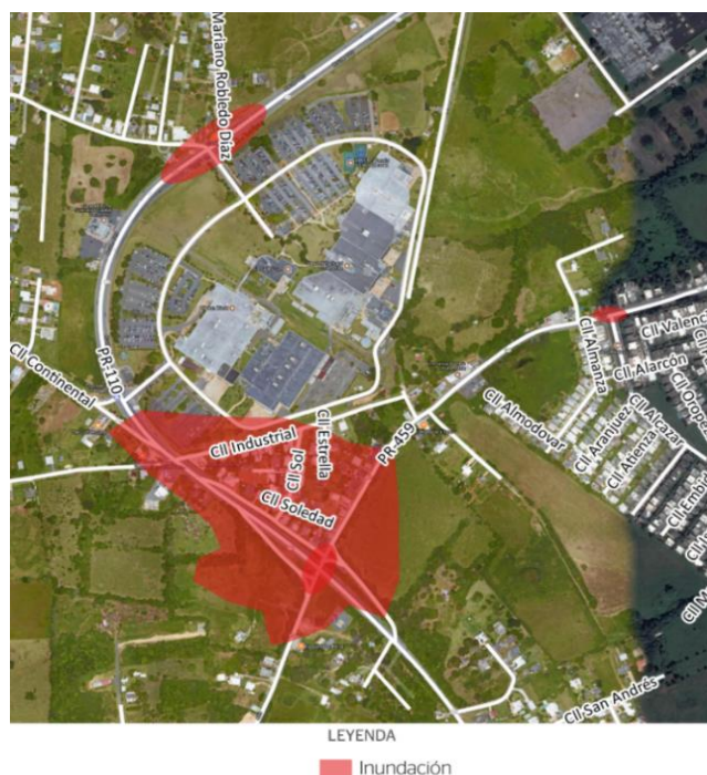
Figura 28. Áreas susceptibles a inundación en las carreteras PR-110 y PR-459
