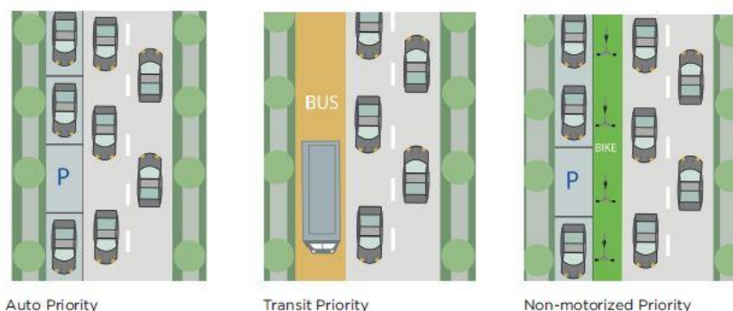
Gráfica 16. Diseño de calles vecinales con alternativas de inclusión de todos tipos de Transportes
