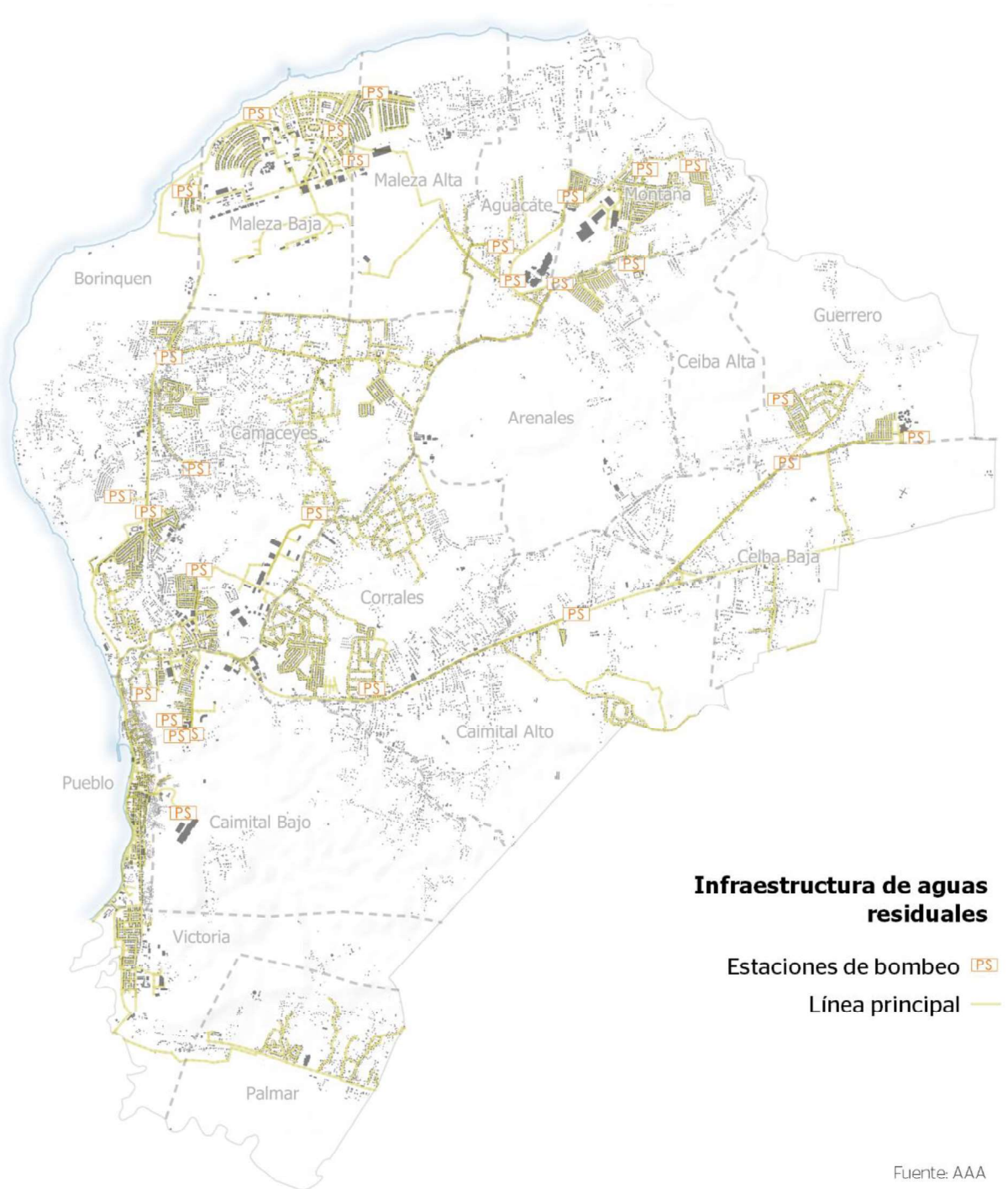
Ilustración 46. Infraestructura de aguas residuales en Aguadilla
